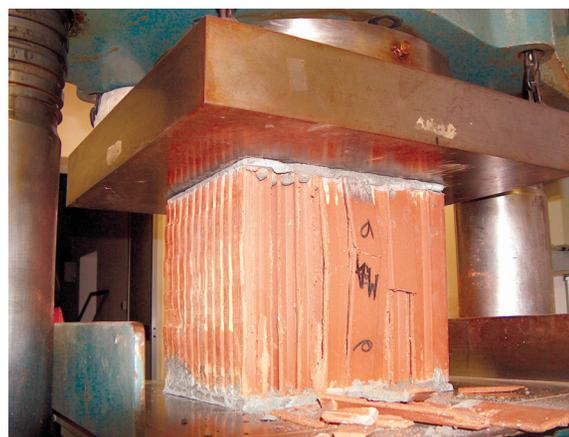
Fig. 1b - Modalità di rottura dei blocchi con cappatura.
