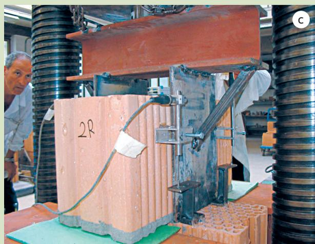
Fig. 3a - Inserimento del provino.
