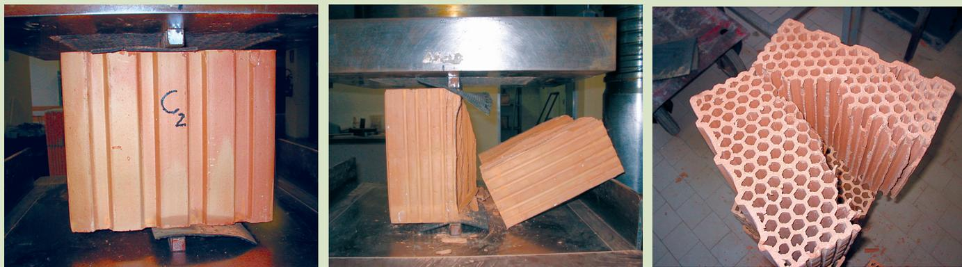
Fig. 2 - Prova di trazione per taglio: modalità di rottura del blocco.
