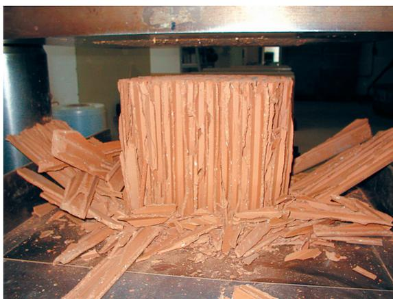
Fig. 1a - Modalità di rottura dei blocchi senza cappatura.
