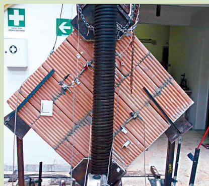
Fig. 7 - Prova di compressione diagonale.
